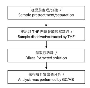
【測試方法/Test method: IEC 62321-8】
